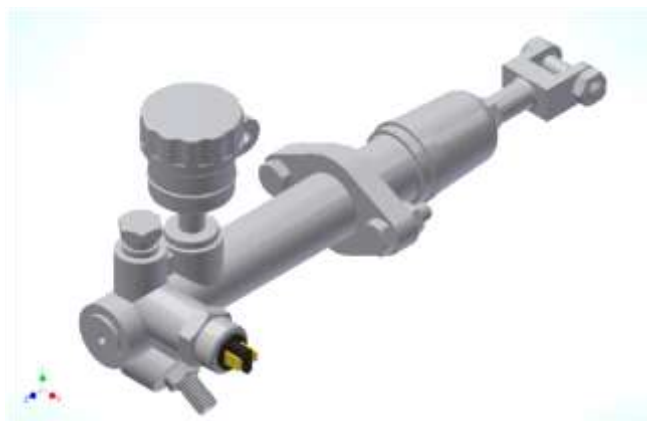
Figura 4. Vista isométrica cilindro maestro. Fuente: (Mora, 2019)
